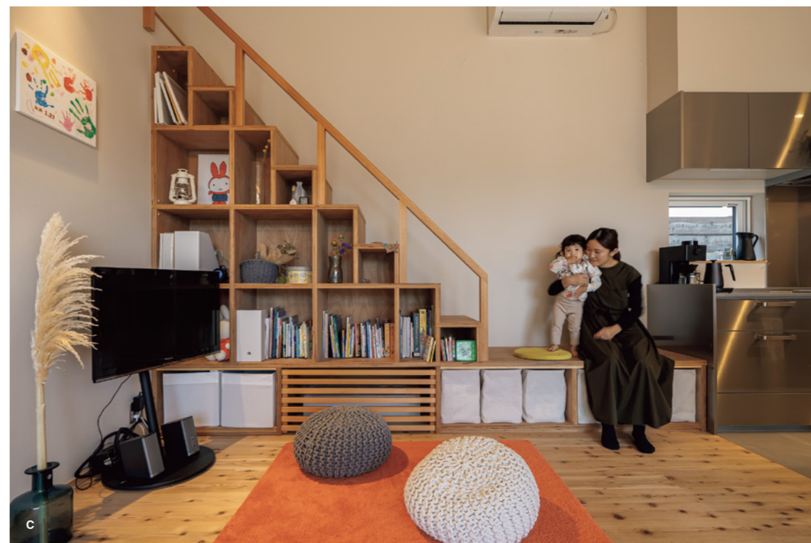
B 家の中心となり、屋内の他の空間や庭をつなぐ基点となるLDK。片流れの屋根の形状を生かした天井に開放感がある。 C 床は県産のスギの無垢材を使用。足に優しく温かい。階段を上るとロフト収納へ至る。階段下のスペースは見せる収納として活用した。
